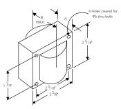
Fig. 9  $(2^{5}/_{8}" \times 2^{3}/_{16}"$  Reactor Core)
